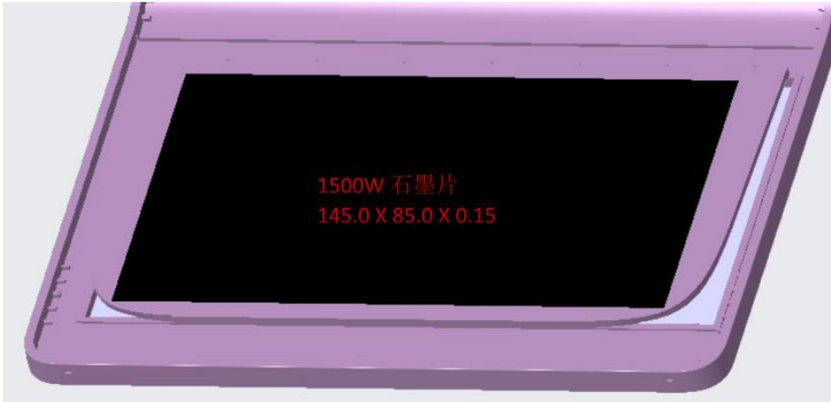
LCD背面胶件上加一块石墨片，防止局部温度过高超过LCD结温
